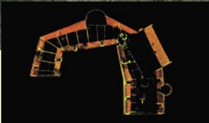
Kasteel Waardenburg - de gedetailleerde inwinning van geometrische informatie, waaruit direct een plattegrond van de werkelijkheid kan worden gemaakt.
