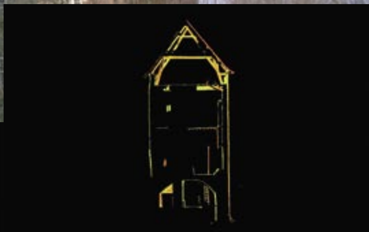
Kasteel Waardenburg - de gedetailleerde inwinning van geometrische informatie, waaruit direct een plattegrond van de werkelijkheid kan worden gemaakt.
